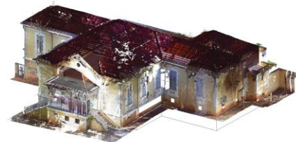
Figura 1. Nuvem de pontos do Palacete importada no REVIT.
