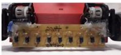
Figura 1. Imagem dos sensores infra-vermelhos.
