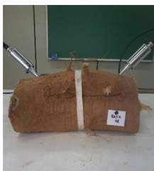
Figura 1. Ensaio de ultrassom indireto com propagação longitudinal de ondas.
