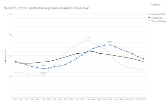
Figura 3. Simulação de Paredes Com Vegetação e Camada de 50 cm de Ar.
