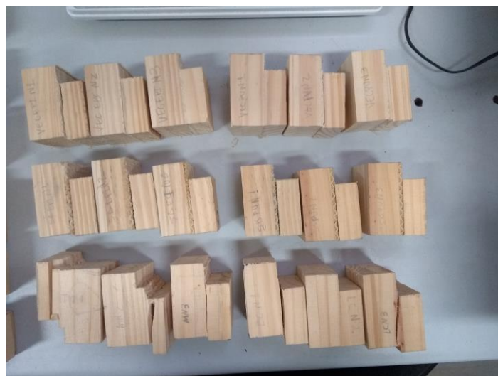
Figura 1. Corpos de provas NBR 7190/1997
