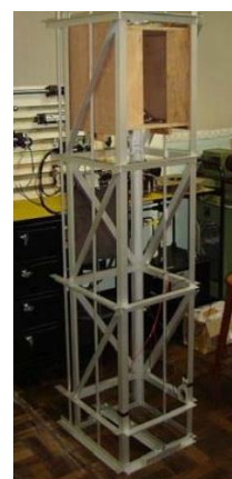
Figura 1. Elevador predial didático com dimensões de 2m de altura, 46cm de largura e 56cm de comprimento.
