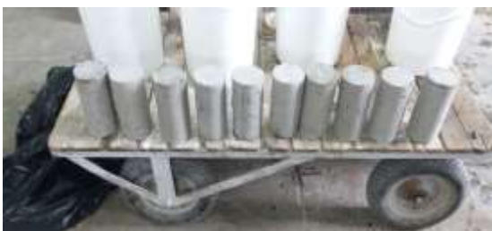
Figura 1: Amostra de corpos de prova fabricados com diferentes composições de água potável e água de reuso.
