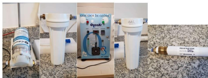
Figura 1. Protótipo do sistema. A) Bomba, 220v. B) Membrana de polietileno. C) Ozonizador. D) Membrana Carvão ativado. E) Membrana de Ultrafiltração.
