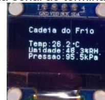
Figura 3. Visualização das medidas das grandezas no display OLED.
