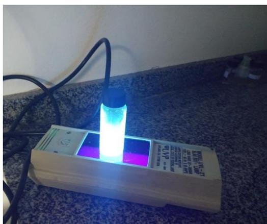
**Figura 6** – Fotografia de uma solução de (N-etilenodiamina-1,8-naftalimida) –  $1,0 \times 10^{-3}$  mol/L em metanol excitado por uma lâmpada de ultravioleta (365 nm).
