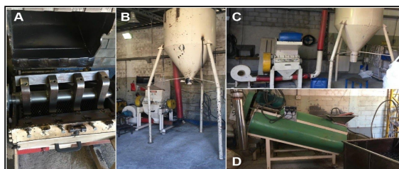
Figura 2. Máquinas para Reciclagem de Plásticos: Moinho (A); Aglutinador (B); Extrusora (C) e Granulador (D).
