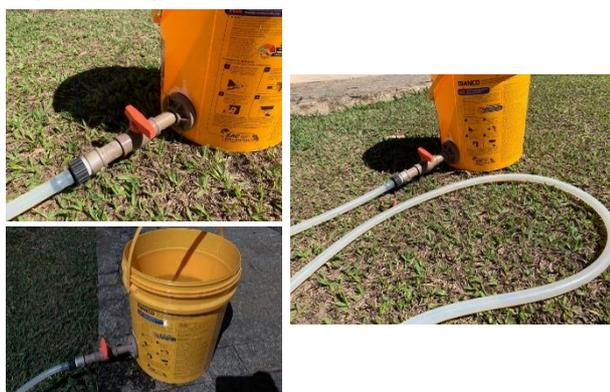
Figura 2: Protótipo do sistema de gotejamento
