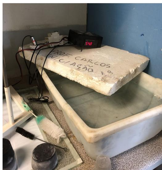
Figura 1. Processo de cura térmica.
