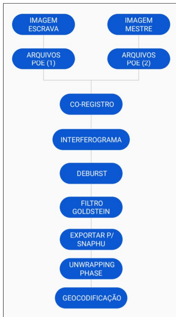
Figura 2: Fluxograma das etapas de processamento necessárias para gerar um mapa de deformação
