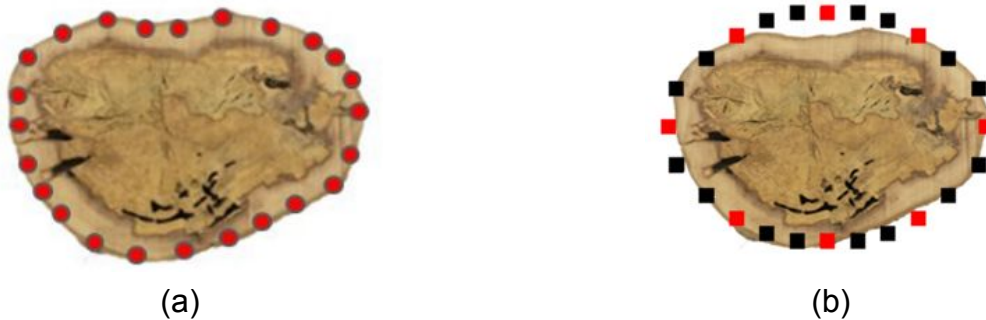
Figura 2. Obtenção do contorno pela metodologia de referência(a) e pelo Software gerador de contorno regular(b).
