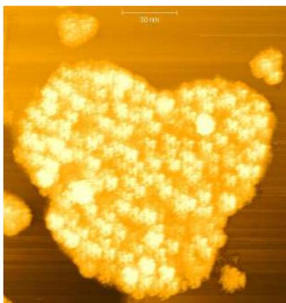
Figura 12: Ilha com aspecto rugoso na amostra de  $\text{HfS}_2$  *pós-annealing*
