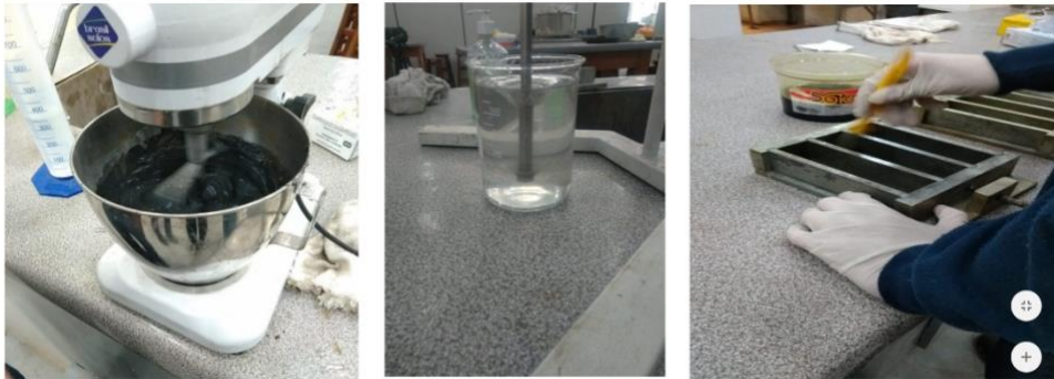
Figura 2 : Produção dos corpos-de-prova prismáticos
