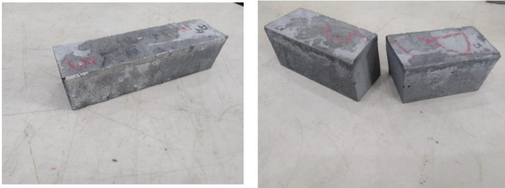
Figura 3: Corpo-de-prova antes e depois do teste de flexão
