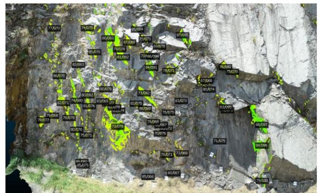
Figura 4. Atitudes das superfícies filtradas obtidas com o *Plane Tool*
