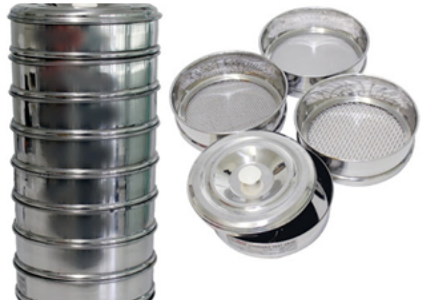
Figuras 02 e 03 - Amostrador Tipo Petersen e Conjunto de Peneiras Granulométricas.
