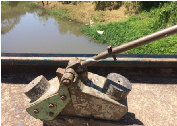
Figuras 02 e 03 - Amostrador Tipo Petersen e Conjunto de Peneiras Granulométricas.
