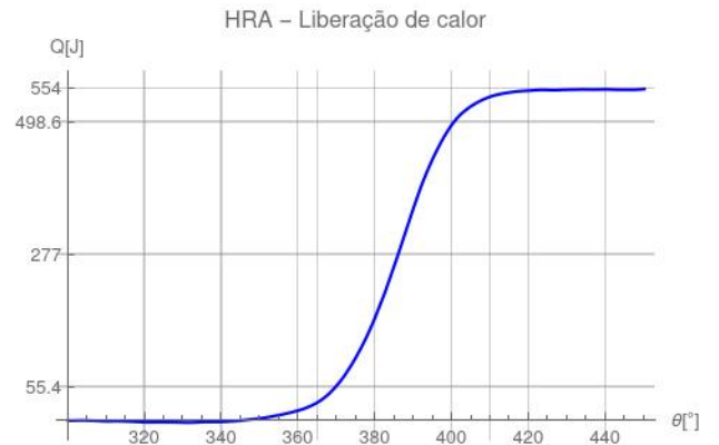
Figura 11: Liberação de calor instantânea do motor em função do ângulo da manivela
