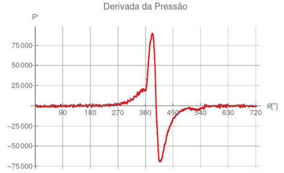
Figura 9: \frac{dp}{d\theta} derivada numericamente e já suavizada por transformada de Fourier - FFT
