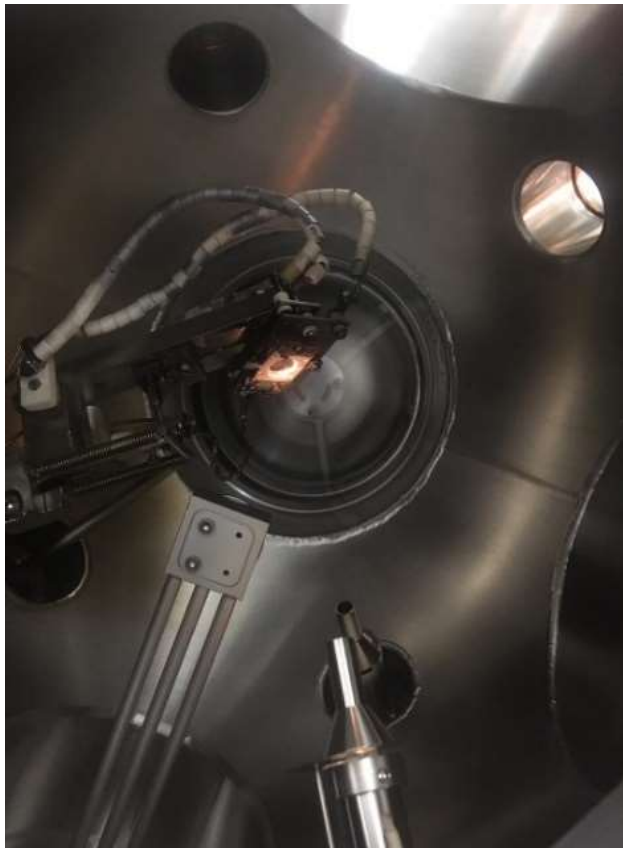
Figura 1. Evaporadora de Háfnio e tubo do gás H_2S posicionados em direção ao porta amostra, durante o primeiro crescimento do HfS_2 sobre o cristal de Ag(111) .
