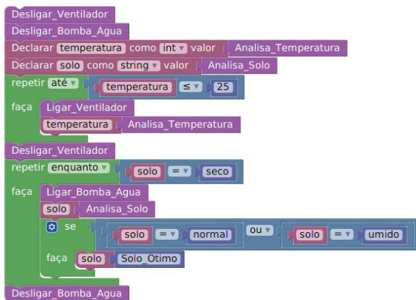
Figura 4 – Programa em linguagem de blocos para o funcionamento da Estufa automatizada.
