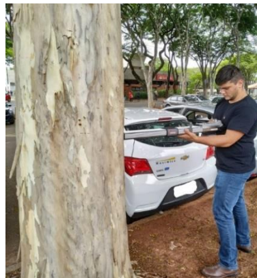
Figura 2 - Ensaio realizado utilizando penetrógrafo
