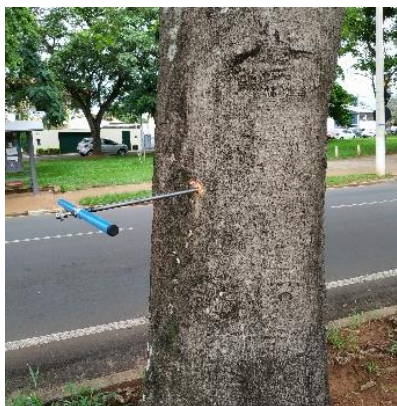
Figura 1 - Amostra sendo retirada com utilização de Trado de Pressler
