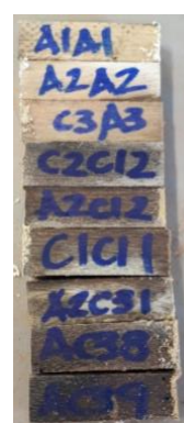
Figura 4: corpos de prova prismáticos identificados segundo sua posição no disco
