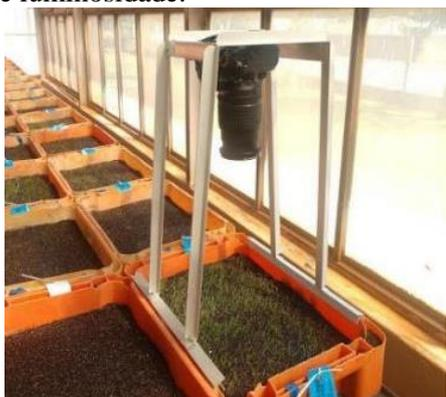
Figura 1 - Câmera acoplada ao suporte, destacando a casa-de-vegetação e a organização das caixas ao fundo.
