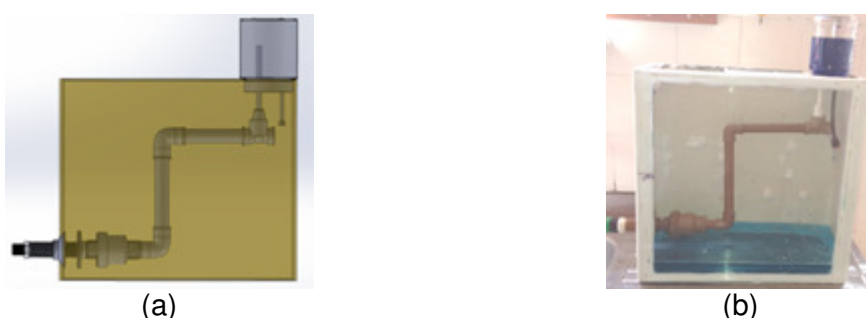
Figura 3 – Desenho esquemático do dosador (a) e protótipo montado em reservatório (b).
