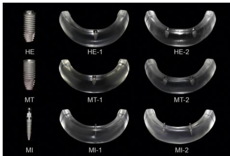
Figura 2: Implantes (HE, MT, MI) e modelos fotoelásticos (HE-1, MT-1, MI1, HE-2, MT-2, MI-2) projetados para cada grupo. EH, hexágono externo. MT, Cone Morse. MI, mini-implante; HE-1 e HE -2, modelos de hexágono externo com 1 e 2 implantes; MT-1 e MT-2, modelos cone Morse com 1 e 2 implantes; MI-1 e MI-2, modelos de mini-implantes com 1 e 2 implantes.
