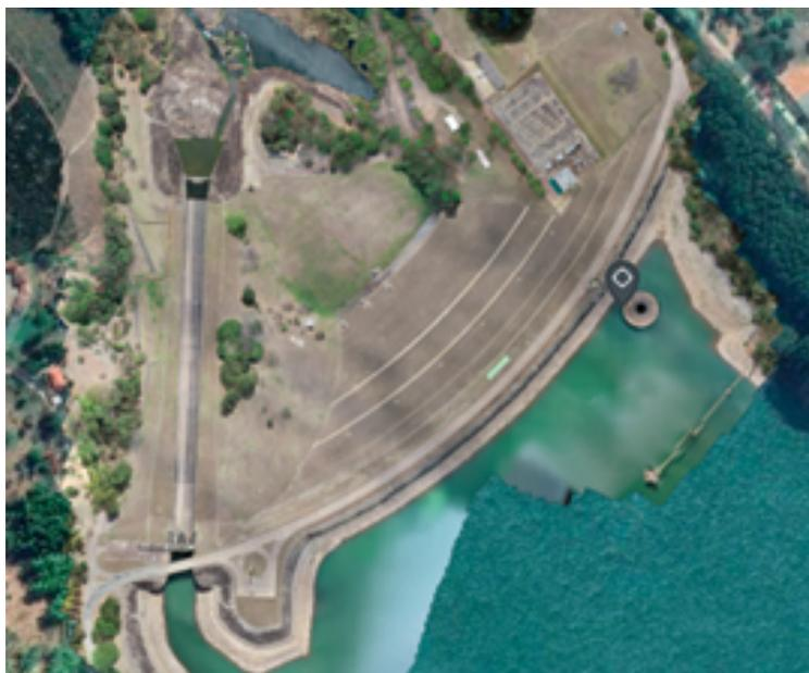
A visão geral da estrutura é feita a partir da sobreposição de todas as fotos em alta resolução obtidas pelo sobrevoo do drone, conforme mostra-se na Figura ao lado. Nota-se que é possível visualizar um panorama da barragem e do seu entorno, o que não seria possível sem um voo realizado em um helicóptero, por exemplo, e que tem um alto custo.
