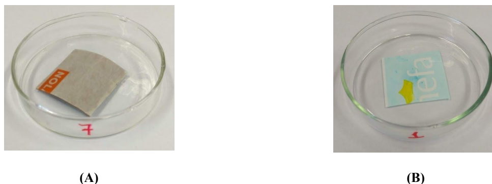
Figura 3 - A) Amostra de embalagem cartonada após submersão em acetona sob agitação por 24 horas à 50°C B) Amostra do material plástico de rótulo após submersão em acetona sob agitação por 24 horas à 50°C (Fonte: Própria Autora).
