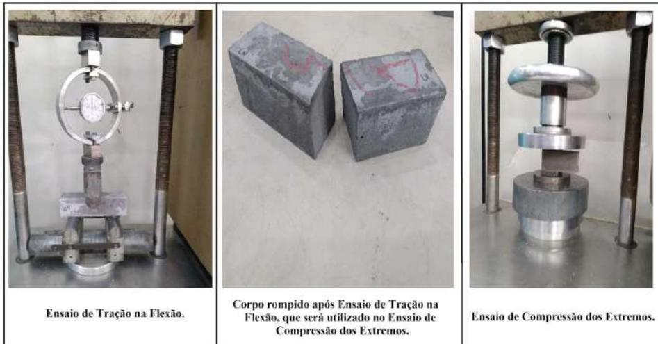
Figura 2.2.3. - Ensaios para análise das propriedades mecânicas dos compósitos estudados.
