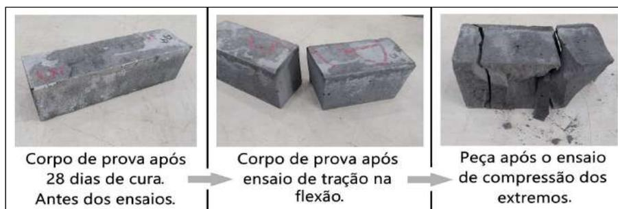
Figura 2.2.3. - Corpo de prova ao longo da segunda parte experimental
