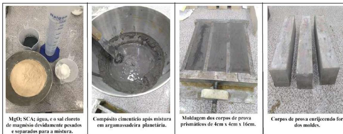
Figura 2.2.1. - Procedimentos para produção dos corpos de prova.
