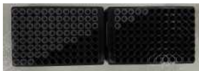
Figura 5: Arranjo das ponteiros empregadas para a deposição dos recobrimentos no pipetador automático. Essa configuração permite a criação de um gradiente de bicamadas variando de 1 a 8.
