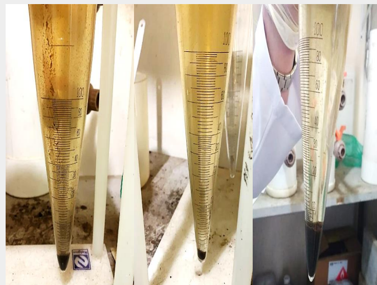
Figura 2 – Resultados de sólidos sedimentáveis realizados em cone de Imhoff
