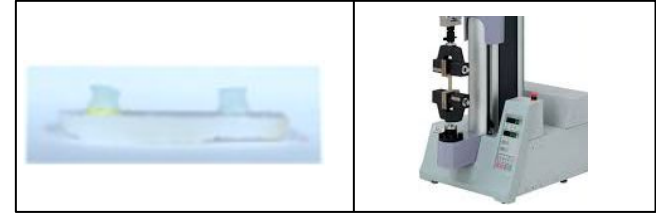
Figura 7. Cilindros de cimento resinoso foram obtidos após fotoativação por 20s (Valo Cordless, Ultradent) (A) e a RUC testada, 24h ou 1 ano após armazenamento em água destilada em estufa, a 37°C, em máquina de ensaio universal (EZ-Test, Shimadzu) (B).
