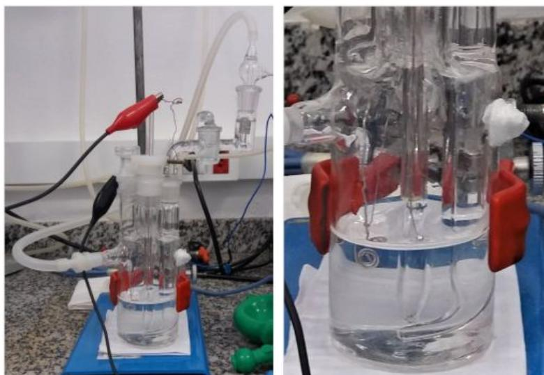
**Figura 2.** Célula eletroquímica de três eletrodos.
