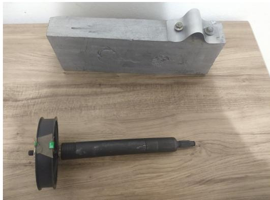
Imagem 5: Base e eixo utilizado na confecção da ferramenta
