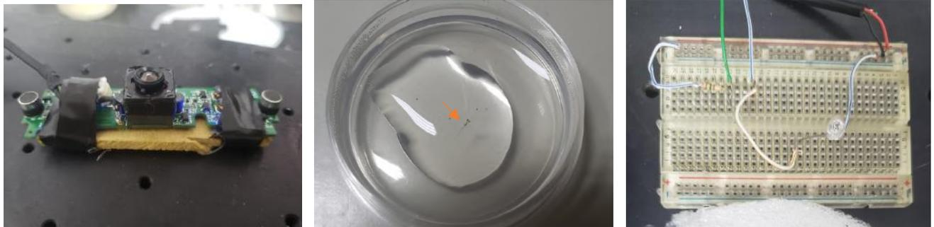
Figura 3 - (esquerda): Montagem experimental da camera desenvolvida a partir da webcam. Figura 2 (centro): imobilização da larva (indicada pela seta) em solução de 1,2% de agarose. Figura 3 (direita): circuito criado contendo uma resistência em série com a luz LED.
