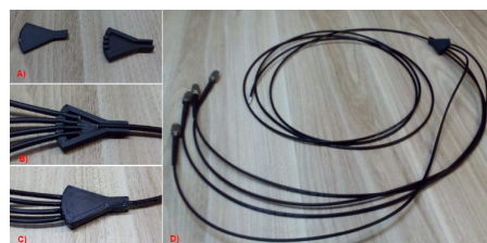
Figura 1. Bundle de fibras ópticas construídas para a detecção da luz no sistema de DCS. À esquerda é possível ver o conector fabricado para acomodar as quatro fibras monomodo.
