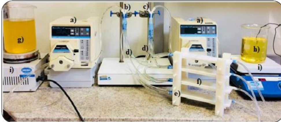
Figura 1. Exemplificação do processo de produção do biodiesel, onde a) são as bombas, b) e c) são os distribuidores de vazão, d) são os tubos que conectam os distribuidores a microplanta, e) é a estrutura de suporte da microplanta, f) são os quatro microrreatores, g) é a mistura de etanol e catalisador, h) é um óleo vegetal e i) são as chapas aquecedoras e agitadoras.
