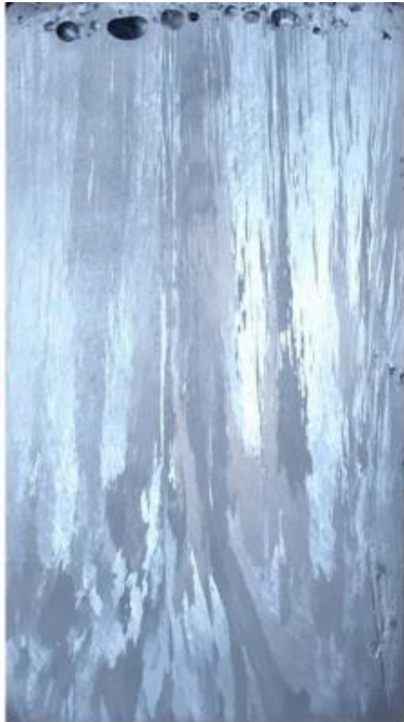
Figura 3 - Macroestrutura da amostra de Al-1,5%Mn seccionada longitudinalmente.
