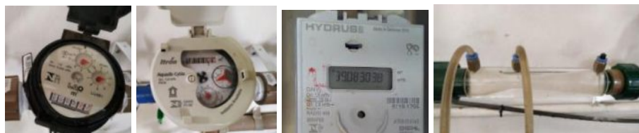
Figura 1: Hidrômetros taquimétrico, volumétrico, ultrassônico e tubo venturi, da esquerda para a direita.
