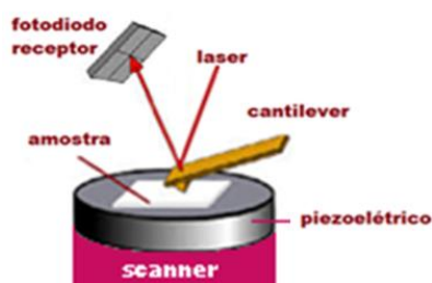
Fig. 1 Esquema representativo do funcionamento do AFM. [11]
