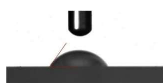
Figura 2. Medição do ângulo de contato da água deionizada por um goniômetro
