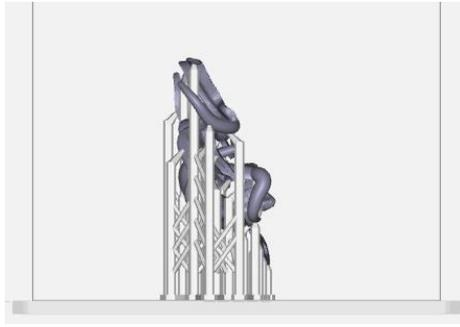
*Figura 03. Vista lateral do desenho de infraestrutura metálica de PPR com suportes de construção angulados.*
