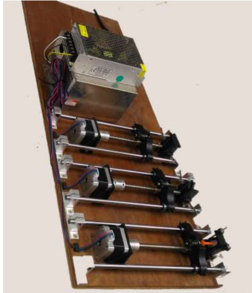
Figura 4: Foto da bomba completa e montada, com as três bases independentes.
