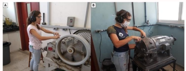
Figura 7: Etapas iniciais para a datação mineral. (A) britagem da amostra; (B) moagem e pulverização da amostra.
