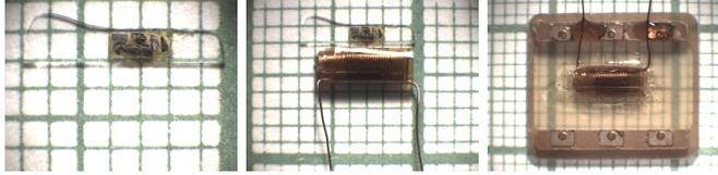
Figura 1: Montagem da amostra de MgB<sub>2</sub>
