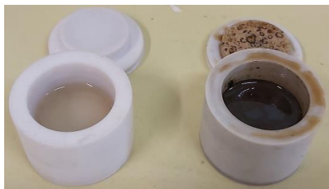
Fig. 3: Coloração das suspensões sintetizadas com Na 3 PO 4 ·4H 2 O (esquerda) e com (NH 4 ) 2 HPO 4 (direita).
