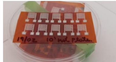
Figura 2: Contatos intermitentes impressos em filme Kapton flexível com tinta condutiva a base de prata.
