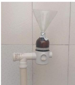
Figura 1. Coletor de amostras de água da chuva por deposição seca e úmida.
