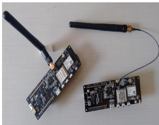
Figura 2 - Duas versões das placas T-Beam que diferem na versão do módulo de rádio LoRa.
