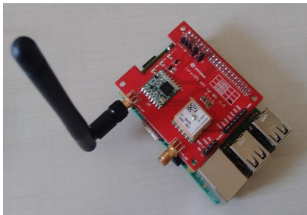
Figura 5 - Receptor P2P usando Shield com LoRa e GPS.
